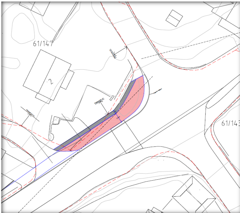
Fig 16: nytt fortau mot Vardåsveien ( kilde COWI)
