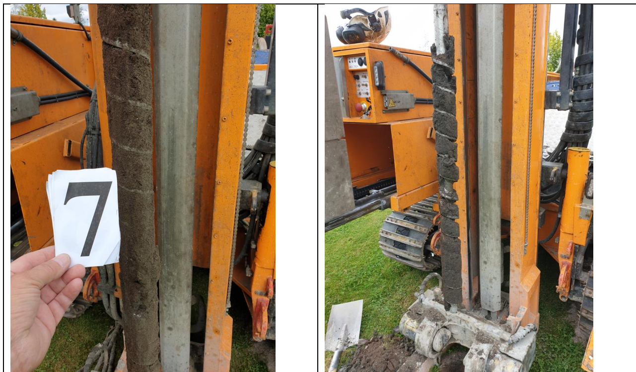
Bilde 7 viser prøvepunkt BP7 dybde 1 meter (til venstre) og dybde 4 meter (til høyre)
