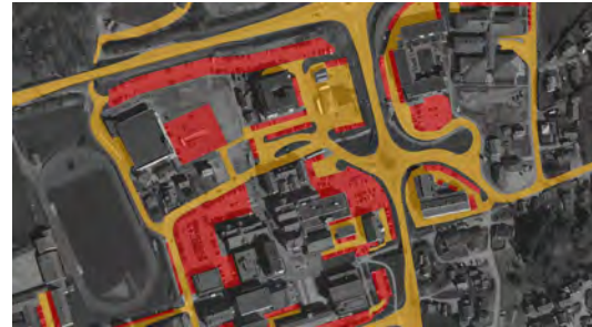
Analysekart som viser bilareal i Tangvall sentrum. Rødt markerer parkeringsplasser mens gult markerer veier.
