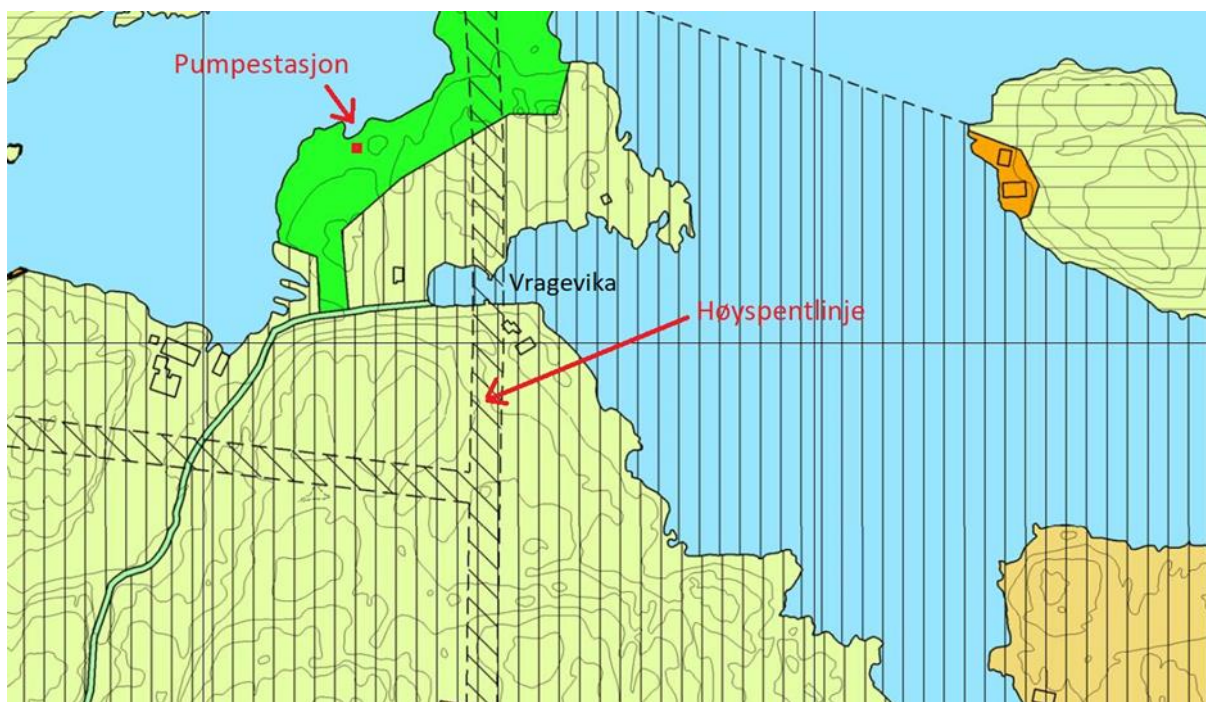
Figur 9 – Utsnitt av gjeldende reguleringsplan. Høyspentlinje går over eiendommen. Pumpestasjon som fører kloakk fra Monsøya til fastlandet ligger nær eiendommen.
