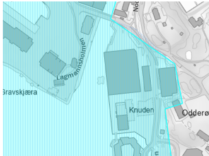
Figur 5-4 Kart over marinleire som grunnforhold ved tiltenkt broplassering (markert i blå) [47]
