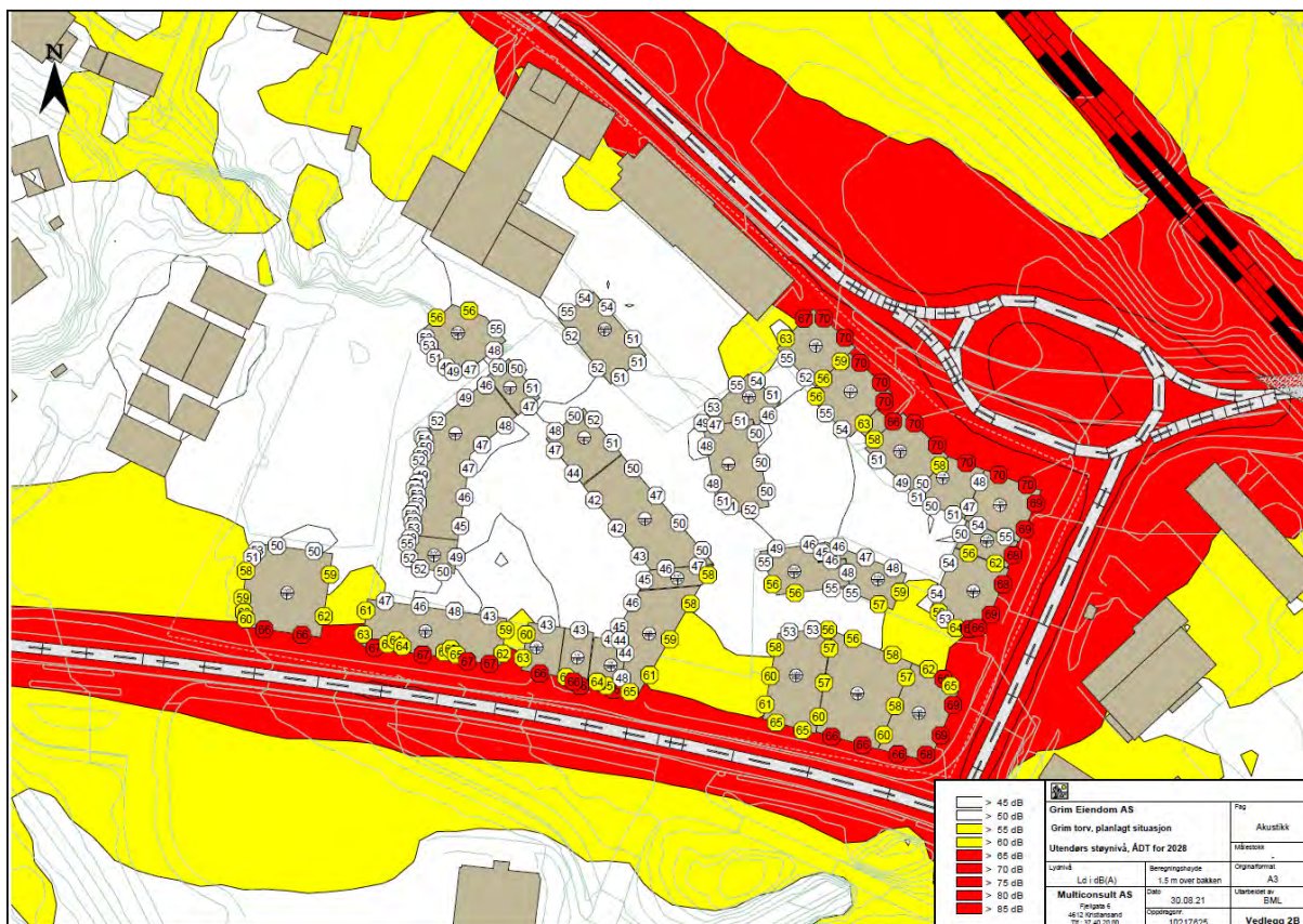
Figur 4-67 Illustrasjonen viser vedlegg 2B i støyrapport - Støysonekart Ld 1,5 m for vegtrafikkstøy og jernbanestøy.
