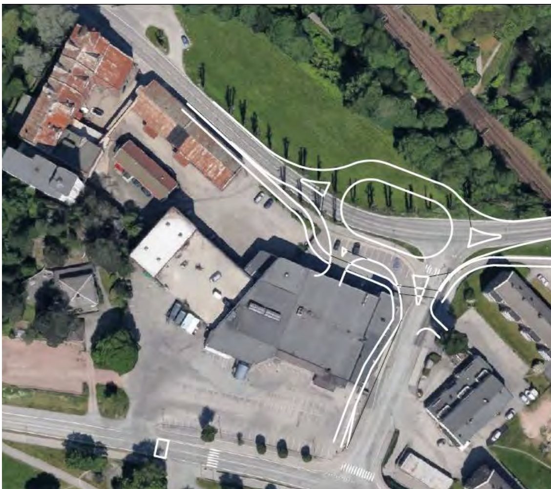
Figur 4-4 Prinsippiel illustrasjon som viser et forslag til ombygging av eksisterende kryss i Rv9/Setesdalsveien til en rundkjøring.
