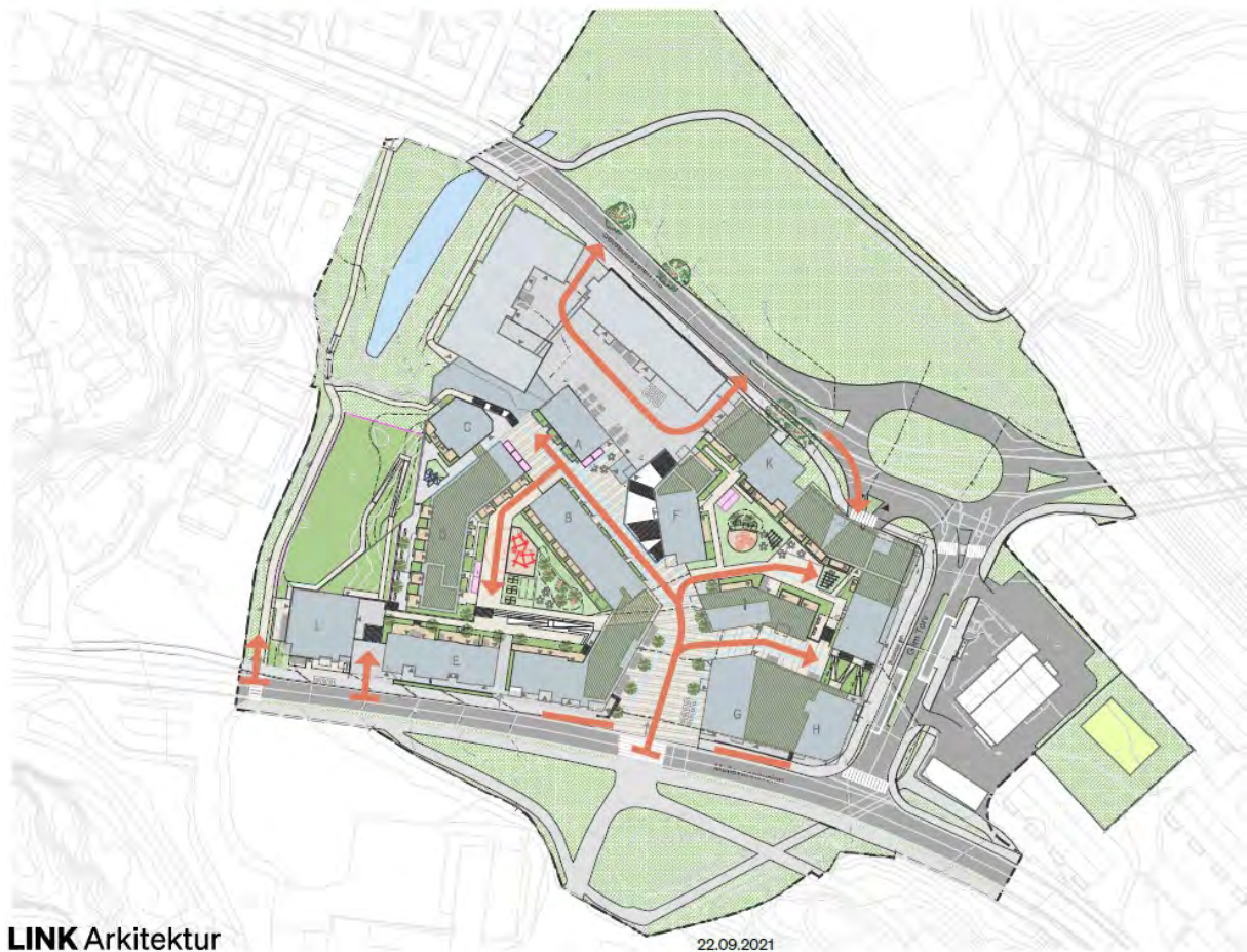
Figur 4-32 Illustrasjon viser mulig tilgang for utrykningskjøretøy.
