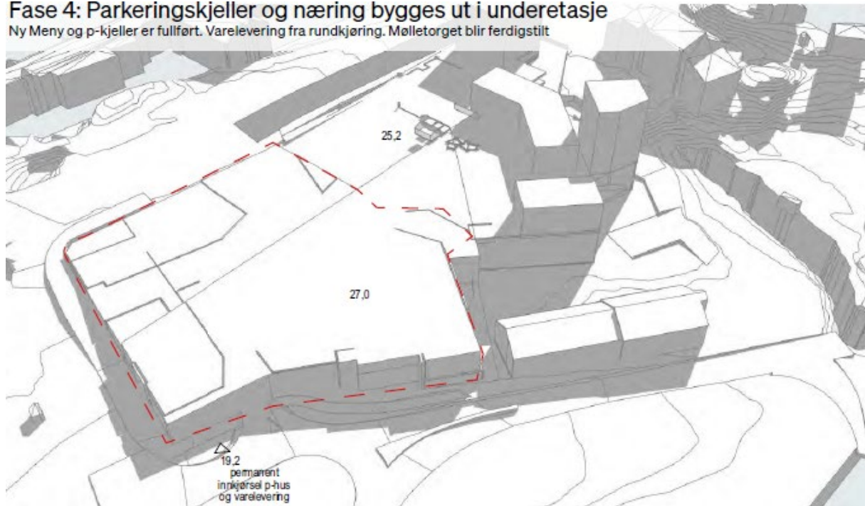
Figur 5-4 Illustrasjon viser fase 4 - etablering av parkeringskjeller og øvrig bebyggelse over parkeringskjeller. Ny Menybutikk i full drift. Varelevering fra parkeringskjeller. Mølletorget blir ferdigstilt.
