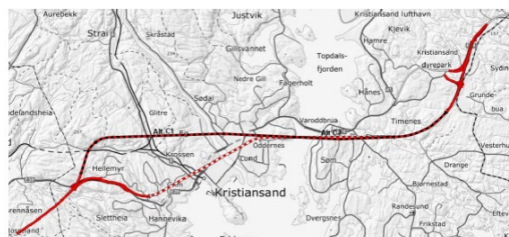
Figur 1-5: Figuren viser et eksempel på alternative trasévalg som ble vurdert i verdianalysen: Tunnel fra Sørlandsparken og under Topdalsfjorden, uten kryss på rv. 9.
