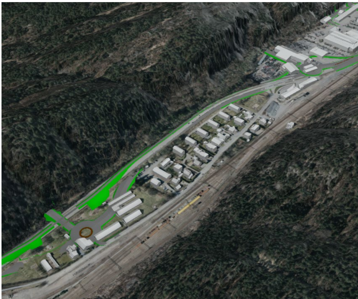
Figur 5-13: 3D-skisse tiltak i dagsone i forbindelse med kryss i berg, sør i Dalane. Fra to nye rundkjøringer på rv. 9 leder nye armer frem til tunnelportaler i åssiden vest for rv. 9, og videre inn i tilførselstunneler frem til kryss med Ytre ringvei i berg. Mellom rundkjøringene må rv. 9 oppgraderes til 4-felt. Det vil også være behov for omlegging av eksisterende gang- og sykkelvei.
