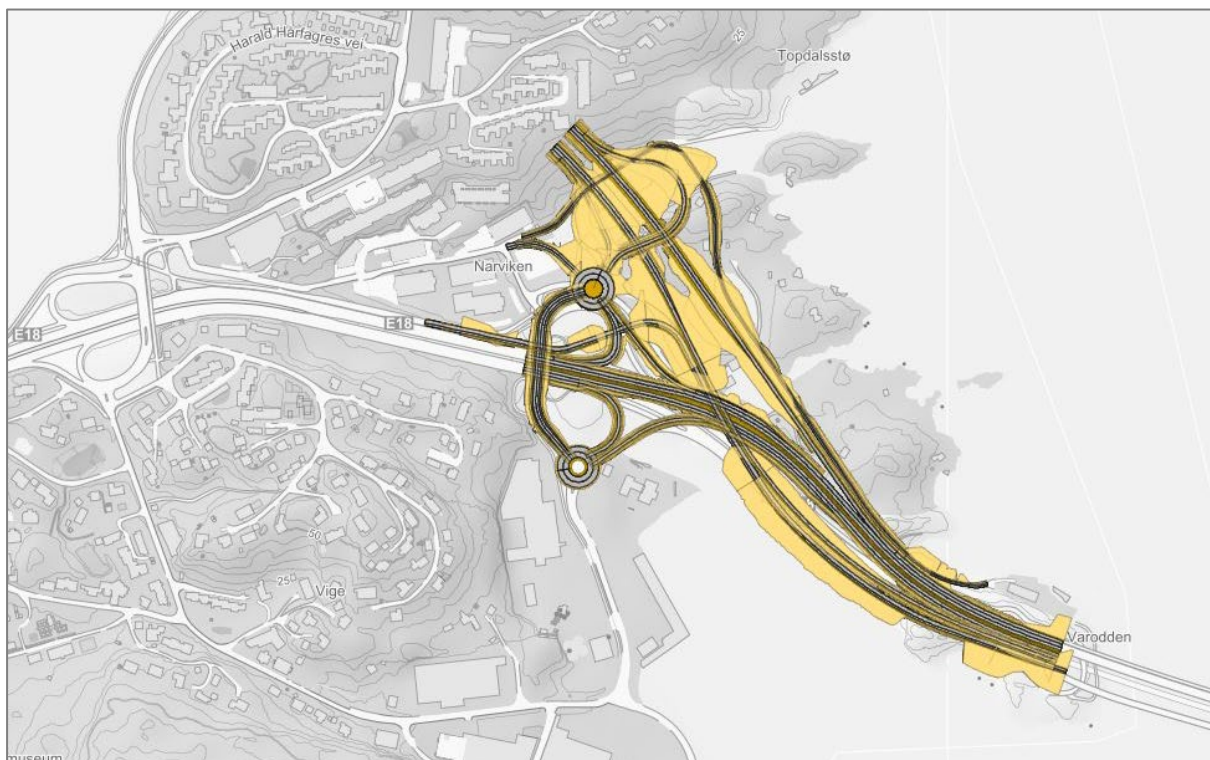
Figur 4-1: Kryssalternativ VN1 i Vige. Krysskonseptet går ut på at ny Ytre ringvei gafler av fra eksisterende E18, krysser over Narviga på fylling og for deretter å gå over i tunnel i sonen nord for E18. Løsningen bygger på anbefalt utbyggingskonsept fra KDP.
