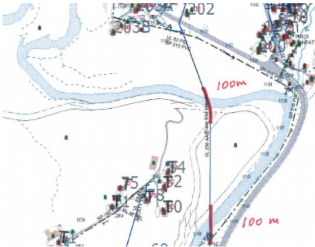
Figur 7: Utskifting av del av vannledningen Nodeland – Røyrvann, elvekryssinger sør for Hortemo.
