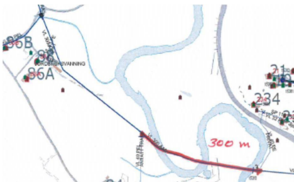
Figur 6: Utskifting av del av vannledningen Nodeland – Røyrvann, elvekryssinger nord for Hortemo.
