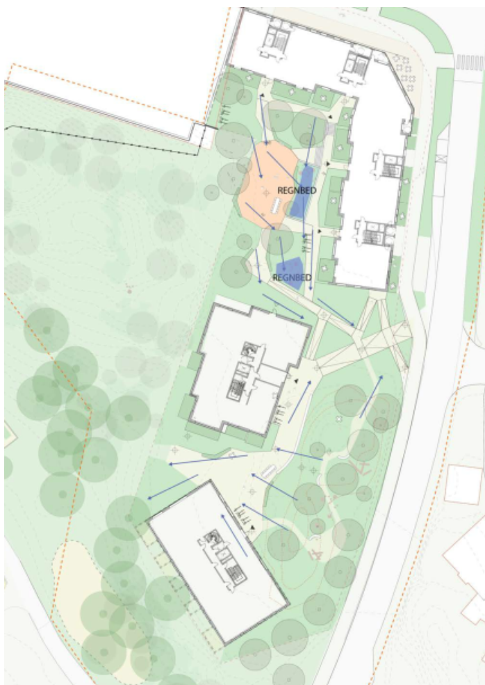
Figur 25: Eksempel på regnbed i gårdsrom
