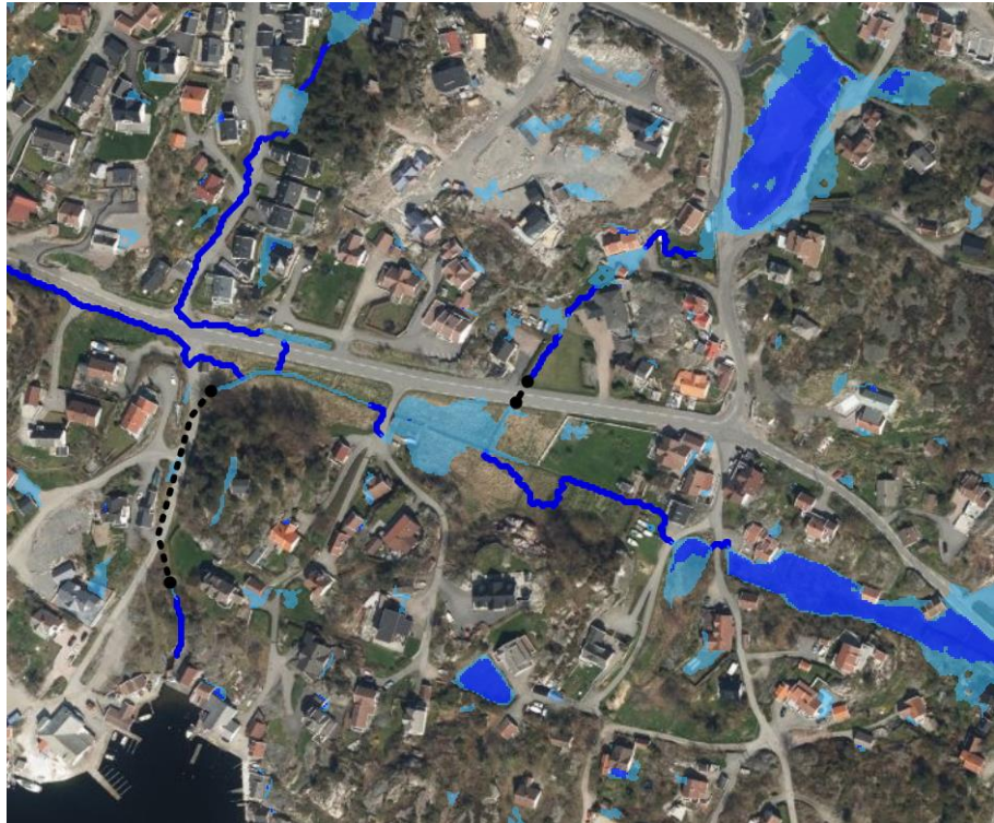
Figur 4: Oversvømte områder med fungerende overvannsledning. Utsnitt fra Scalgo
