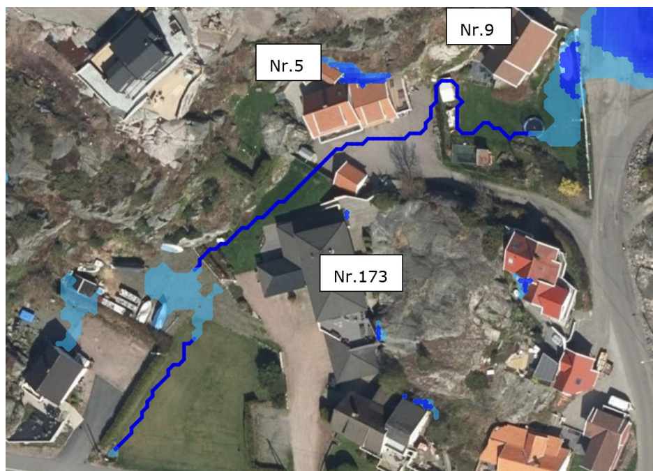
Figur 9: Oversvømte arealer etter tiltak. Utsnitt fra Scalgo
