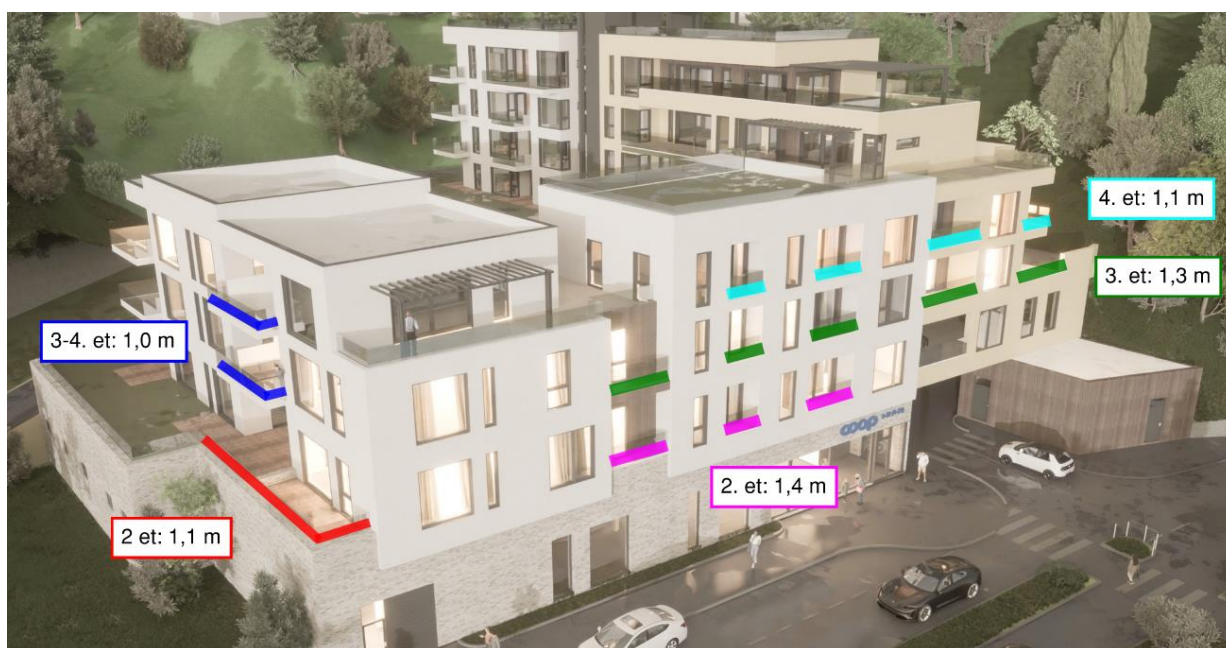
Figur 4 – Skjermingstiltak, tette rekkverk på private uteplasser (+ lydabsorberende himling)
