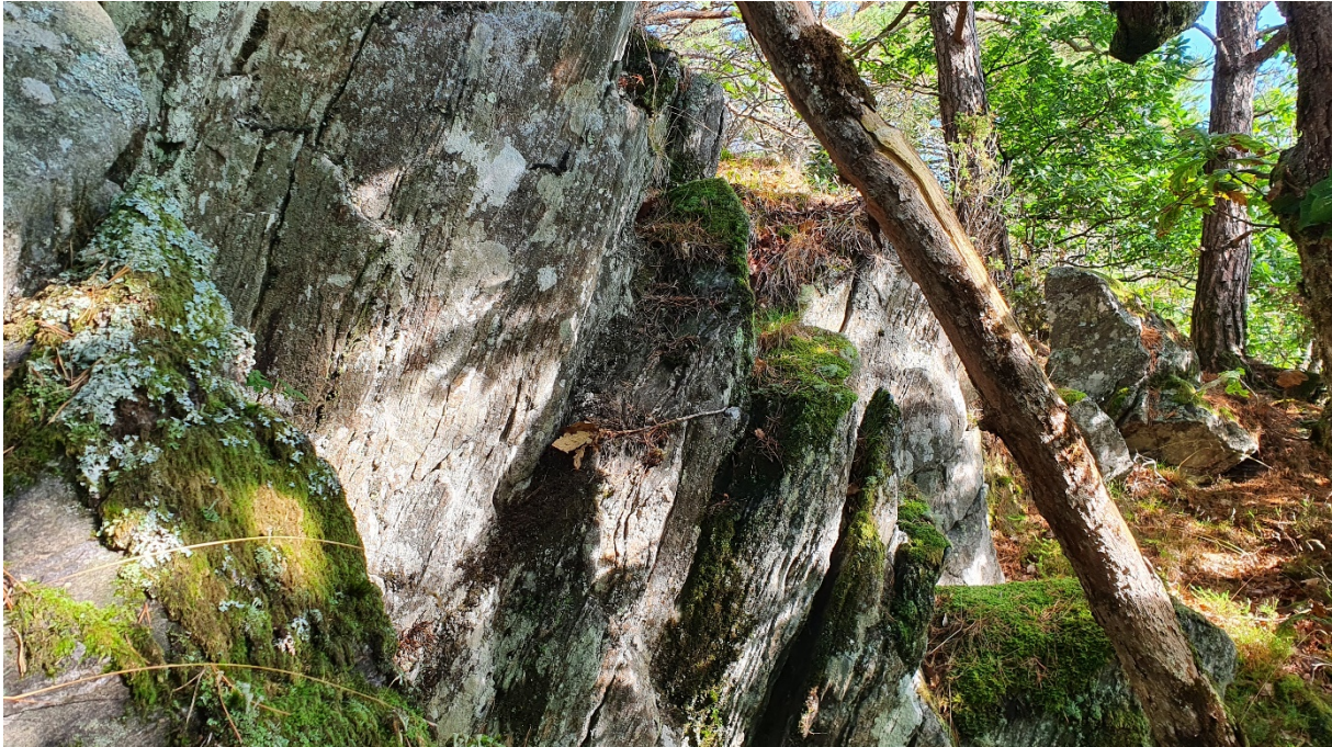
Figur 15 Bilde fra befaringspunkt nr. 1 viser tydelig foliasjonen til bergmassen med steilt fall mot venstre i bilde (mot vest).
