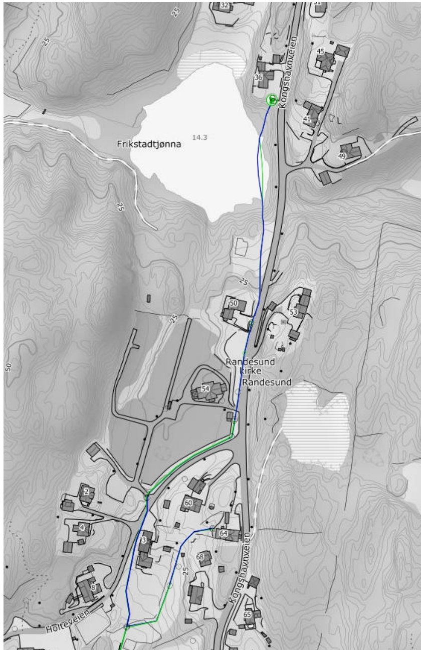
Figur 2-4: Eksisterende kommunale vannledninger
