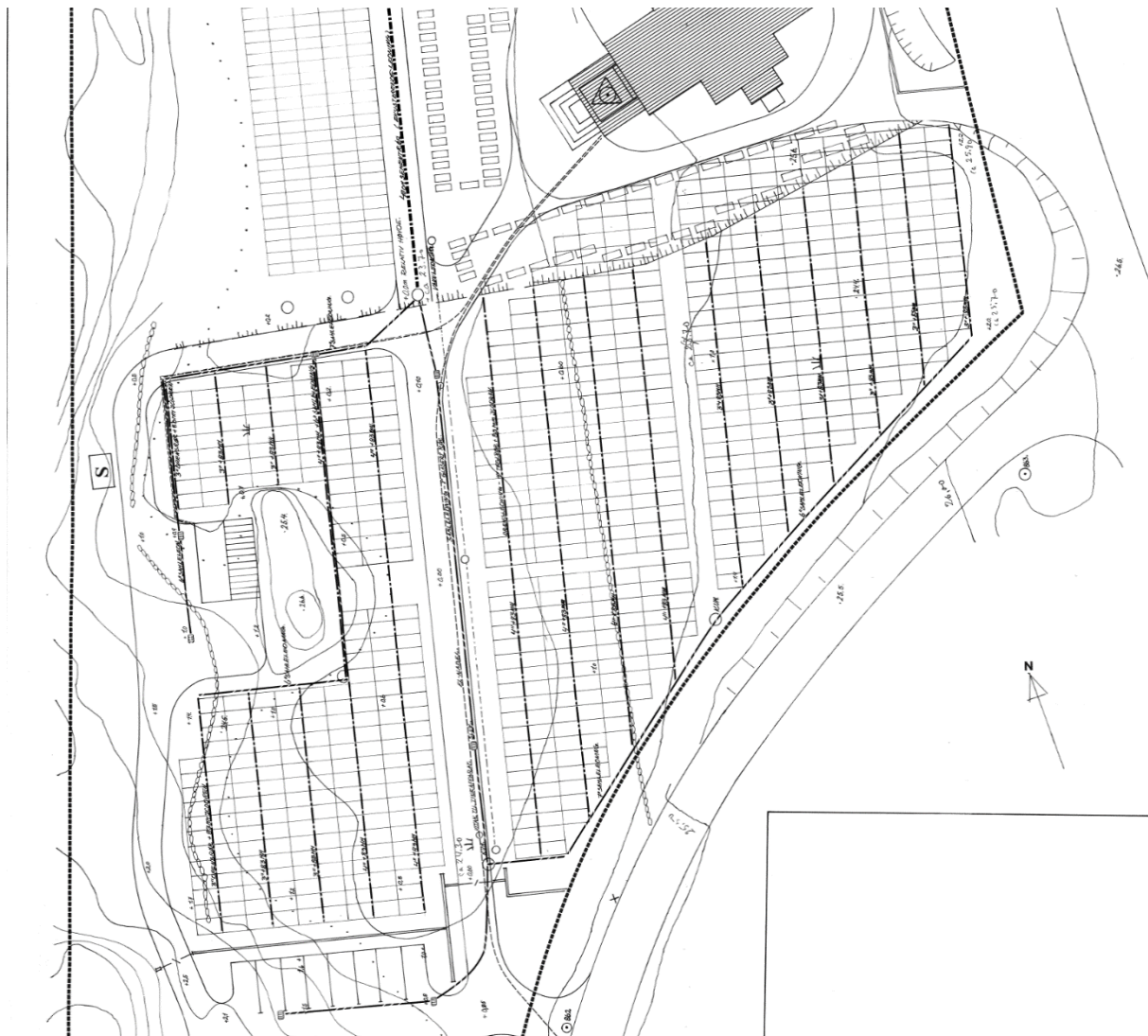
Figur 2-5: Tegninger over drens-system fra byarkivet
